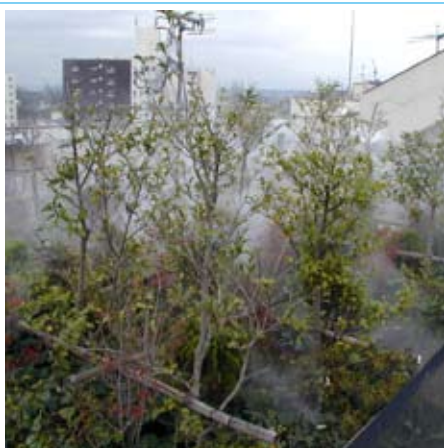
東京農業大学 フォグシステム 東京都 ■屋上緑化のミスト散水効果試験の様子。大学等研究機関への協力作業事例。
