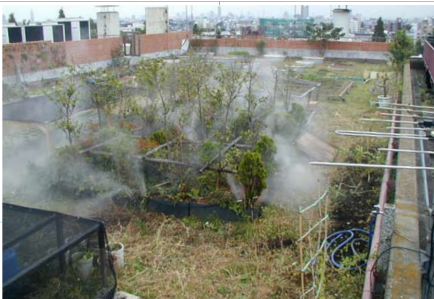
東京農業大学 フォグシステム 東京都 ■屋上緑化のミスト散水効果試験の様子。大学等研究機関への協力作業事例。
